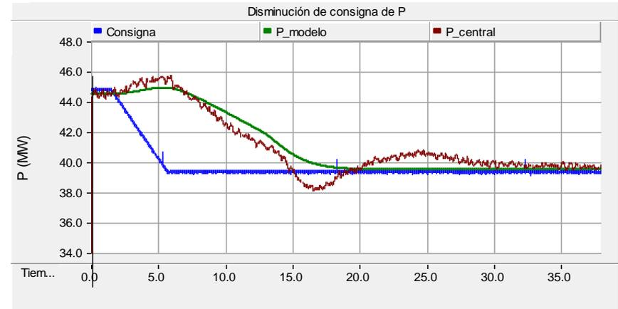
Comparação dos registros de ensaios e da resposta do modelo ante uma redução na consigna do regulador da velocidade.
